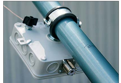
Bild 13: Die Befestigung der Anschlussdose am Mast erfolgt mit einer Klemme.
