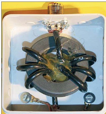
Bild 11: W1JR-Balun für 1 kW mit Aircell 5 auf einem FT240-43 Fotos: DK7ZB
