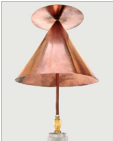
Bild 1: Discone-Antenne mit f_u = 1 GHz und 60 mm Scheibendurchmesser
