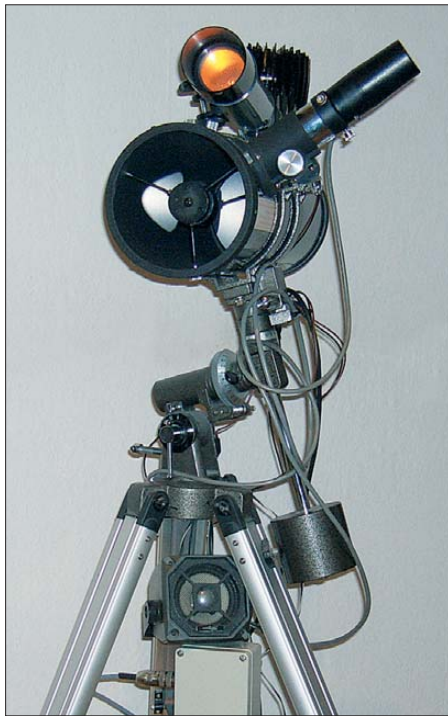
Bild 1: Für erste Versuche fand der Empfänger in einem preiswerten Spiegelteleskop seinen Platz. Für den Sender wurde ein Biliteleskop umgebaut. Foto: Sander
