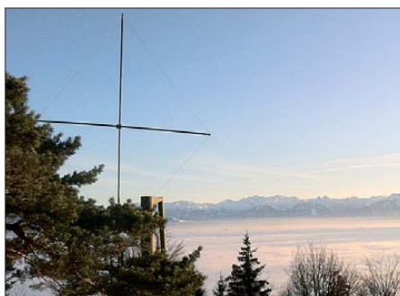
Aktive Loop für die Lowbands am Empfangsstandort des Autors in Reute/AR Foto: HB9AZT
