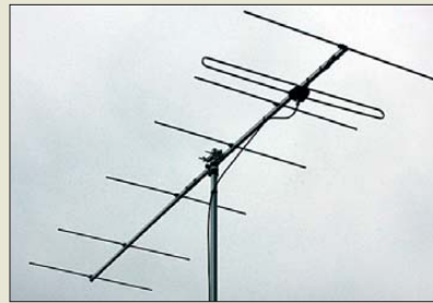
7-Element-Yagi für das 2-m-Band nach DK7ZB
