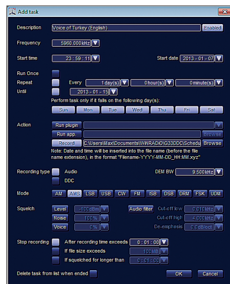
Bild 9: Der Aufnahmebetrieb (HF-Spektrum und NF-Signale) ist per Programmierung umfangreich automatisierbar.
