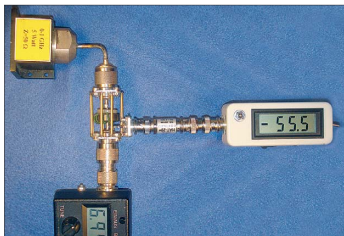
Bild 1: Leistungsmessgerät PWRM 1 (r.), hier über ein 20-dB-Dämpfungsglied an einen Eigenbau-Stromwandler angeschlossen; oben Abschlusswiderstand, unten ein (veralteter) stabo RF Analyst als HF-Generator
