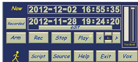
Bild 3: Während der Wiedergabe eines Mitschnitts steht in der unteren Datum-Zeit-Zeile die sekundengenaue Aufnahmezeit.
