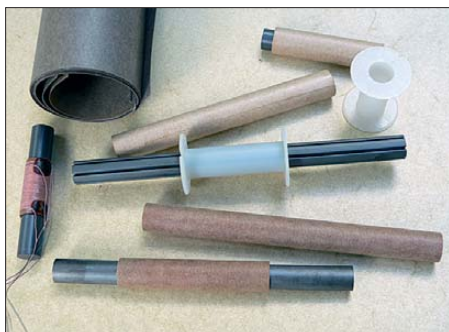
Bild 1: Material zum Bau von Ferritantennen; Wickelkörper und Wickelhülsen reduzieren die wirksame Kapazität zwischen Kern und Wicklung.
