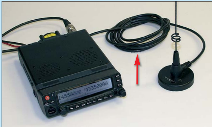
Bild 1: Dünn und kurz – aber trotzdem eine HF-Übertragungsleitung, auf der die herrschenden Verhältnisse komplizierter sind als beim Netzkabel eines Bügeleisens
