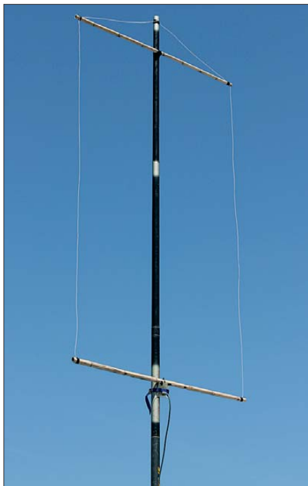
Bild 1: Die 50-Ω-Oblong für das 6-m-Band besitzt hier in der Experimentalausführung Bambusstäbe als Spreizer.
