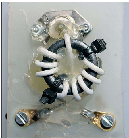
Bild 10: W1JR-Strombalun für 200 W HF auf einer Isolierplatte
