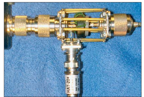
Bild 7: Eigenbau-Stromwandler im Detail; am Messausgang (unten) ist ein kommerzielles 20-dB-Dämpfungsglied nachgeschaltet.
