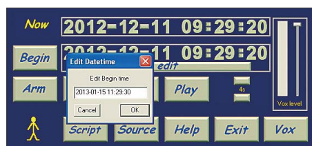
Bild 6: Dank einer Schaltuhrfunktion lassen sich Start- und Endzeit einer Aufnahme sekundengenau programmieren. Bei VOX-Betrieb aktiviert sich die Aufnahme dann nur während dieser Zeitspanne.
